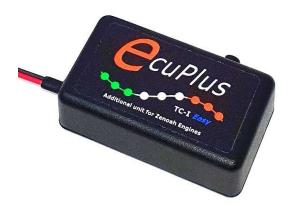
EcuPlus® TC-I *Easy* è una centralina per il controllo della fasatura d'accensione compatibile con i sistemi di accensione TCI-IKEDA per i volani d'accensione con due magneti di diametro 60, 70 e 89 mm.
