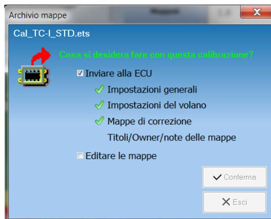
Se viene spuntata l'opzione "inviare alla ECU", con il pulsante conferma verrà dato inizio il trasferimento della calibrazione alla EcuPlus. Al termine dell'operazione che durerà 30 secondi circa, la Ecu sarà pronta per essere utilizzata.
